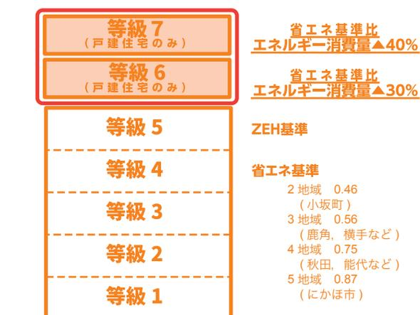
図6 断熱等級の割り付け
