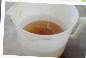
分離された水・サビ 透明部分：灯油 茶色部分：サビやゴミを含んだ水
